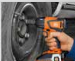
Uvoľnenie extrémne pevne sediacych skrutiek
